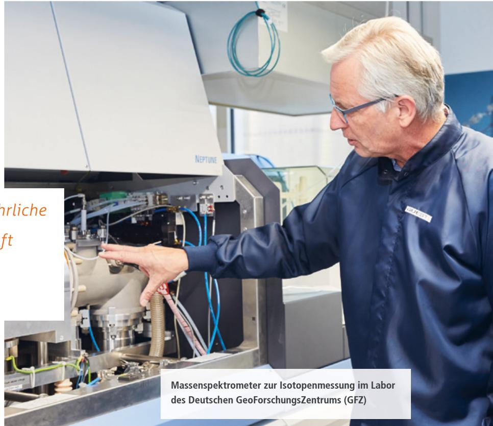
Massenspektrometer zur Isotopenmessung im Labor des Deutschen GeoForschungsZentrums (GFZ)
